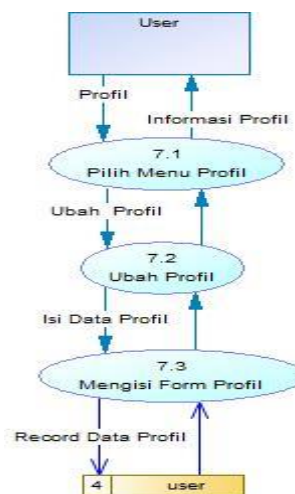
Gambar 3.9 DFD Level 1 Proses Mengelola Ubah Profil User
